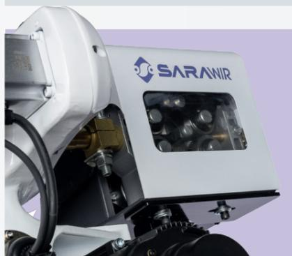
Para un mejor arrastre del hilo, la devanadora SARAWIR posee cuatro rodillos para hilo desde 0,8 hasta 1,6mm. Con conexión y comunicación directamente al controlador para una mayor eficiencia.
